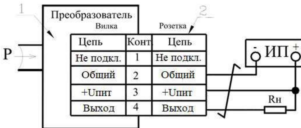
Рисунок В.2 Схема подключения преобразователя с кодом «С» выходного разъема по таблице А.1
