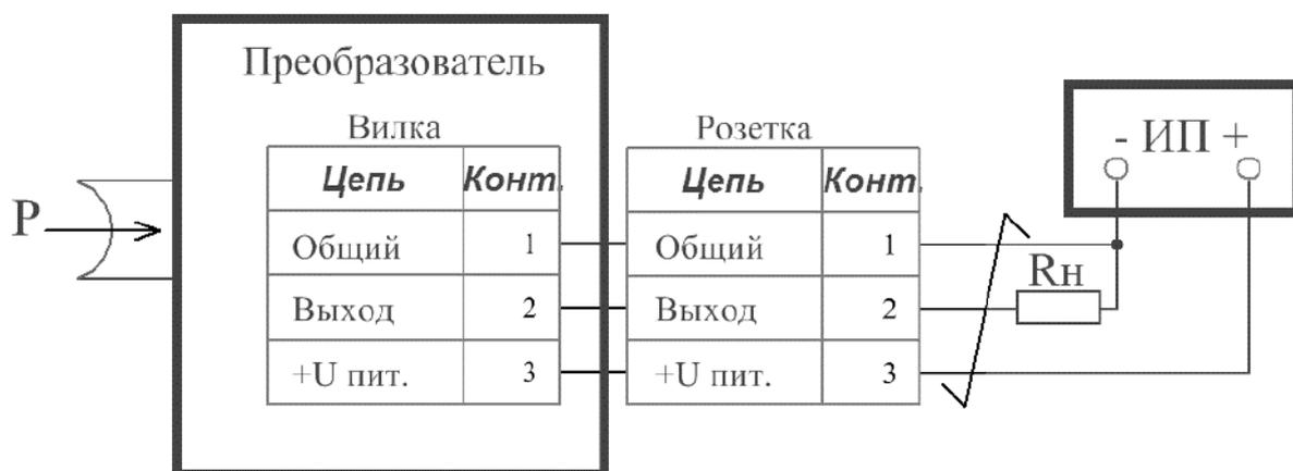
Рисунок В.1 Схема подключения преобразователя с кодом «В» выходного разъема по таблице А.1
